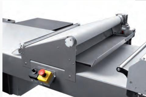
Подача теста на стол для нарезки может осуществляться посредством прямого перемещения тестового полотна на транспортер или при помощи скалки со скрученным тестом.
