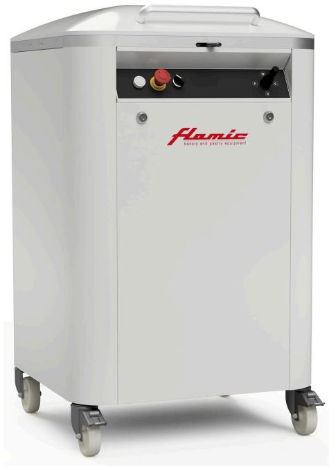
Полувтоматический тестоделитель Flamic SR SA 20 с гидравлическим управлением обеспечивает высокую точность при разделе теста на порции.
