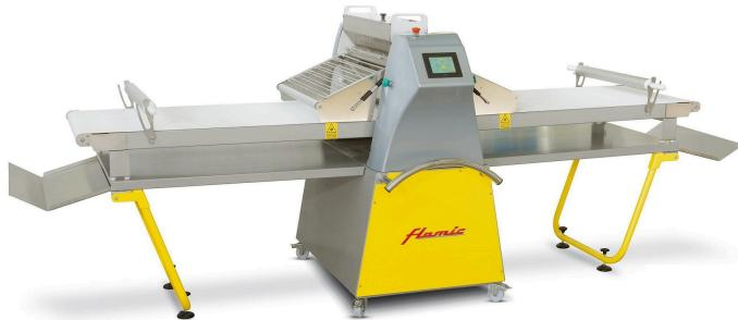
Тестораскаточные машины FAST700P подходят для больших кондитерских цехов, лабораторий, которые используют автоматическую обработку изделий из теста на основе рецептов, сохраненных в памяти сенсорной панели управления.
