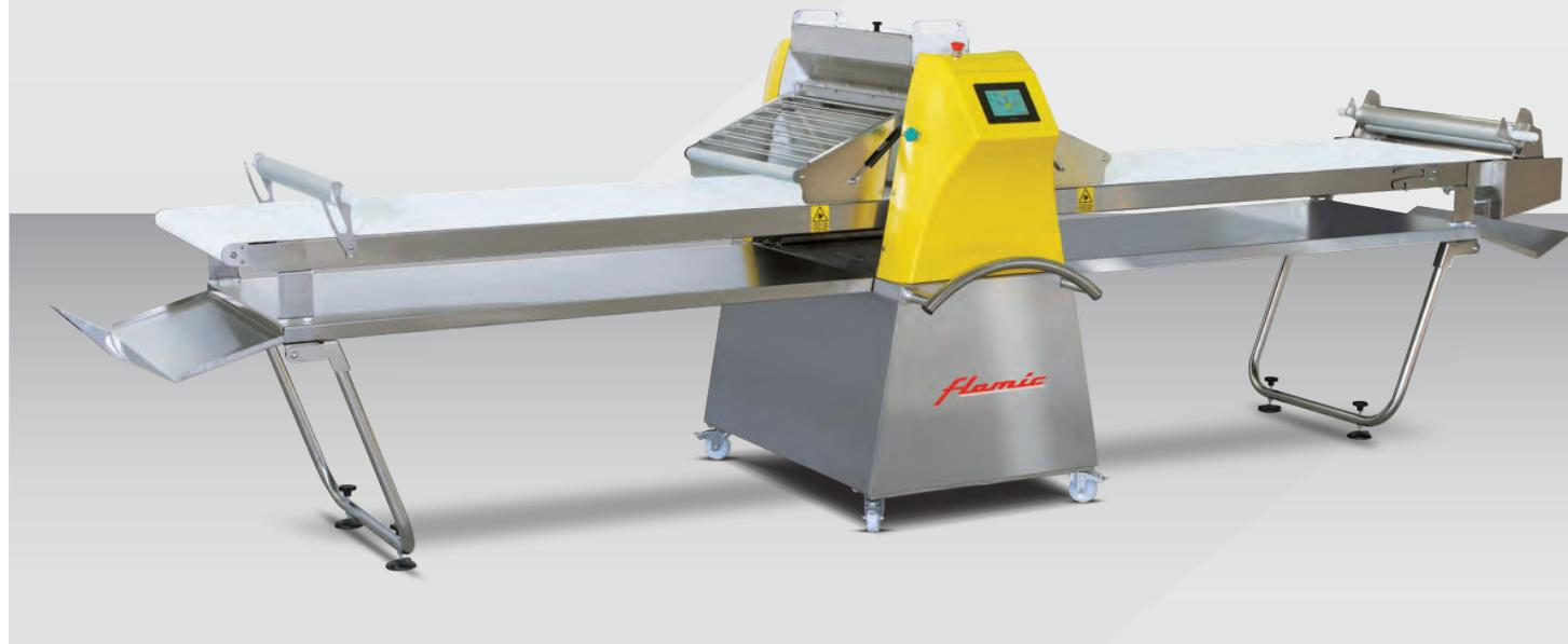
**Máquinas indicadas para grandes pastelerías que permiten un ciclo automático de elaboración de la pasta a través de recetas memorizadas en la pantalla táctil.**
