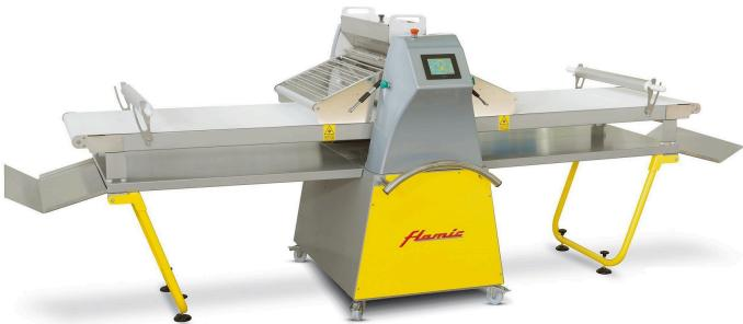
Тестораскаточная машина Flamic FAST700X2000 подходит для больших кондитерских цехов, лабораторий, которые используют автоматическую обработку изделий из теста на основе рецептов, сохраненных в памяти сенсорной панели управления. Воздействует на тесто с помощью валиков и превращает массу в ровный пласт нужной толщины. В результате получается идеально раскатанный пласт теста, готовый к дальнейшей обработке.
