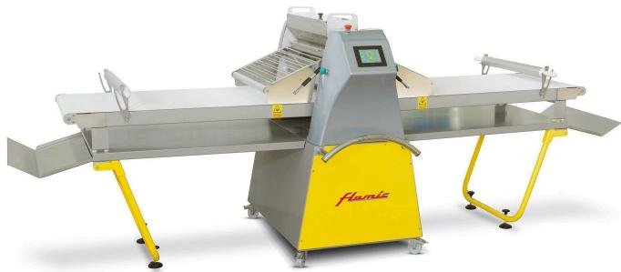
Тестораскаточная машина Flamic FAST700PX1500 подходит для больших кондитерских цехов, лабораторий, которые используют автоматическую обработку изделий из теста на основе рецептов, сохраненных в памяти сенсорной панели управления. Воздействует на тесто с помощью валиков и превращает массу в ровный пласт нужной толщины. В результате получается идеально раскатанный пласт теста, готовый к дальнейшей обработке.
