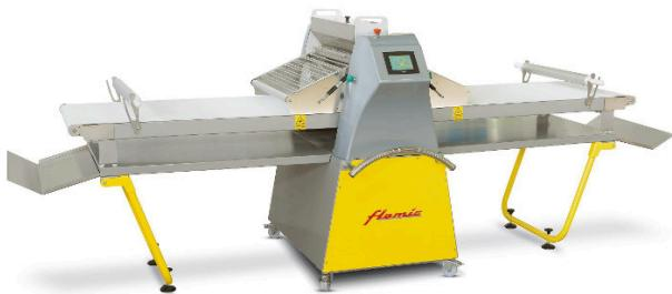
Тестораскаточная машина FAST 700-1500 подходит для больших кондитерских цехов, лабораторий, которые используют автоматическую обработку изделий из теста на основе рецептов, сохраненных в памяти сенсорной панели управления.
