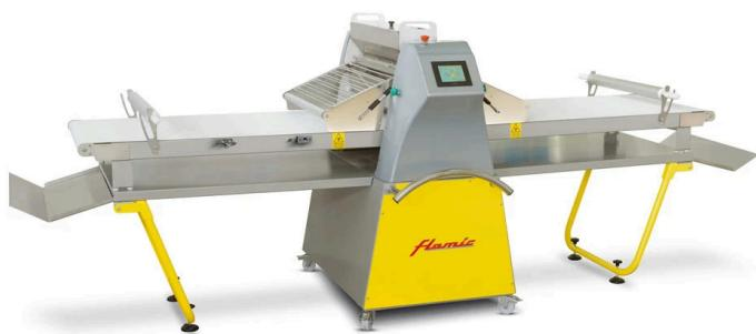
Тестораскаточные машины FAST700PAV-1500+PST с автоматической намоткой на скалку подходят для больших кондитерских цехов, лабораторий, которые используют автоматическую обработку изделий из теста на основе рецептов, сохраненных в памяти сенсорной панели управления.
