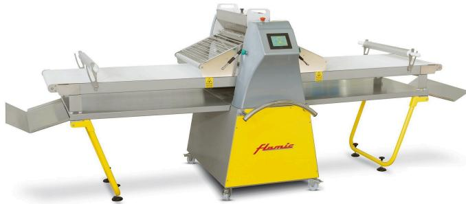
Тестораскаточная машина Flamic FAST700PX2000 подходит для больших кондитерских цехов, лабораторий, которые используют автоматическую обработку изделий из теста на основе рецептов, сохраненных в памяти сенсорной панели управления. Воздействует на тесто с помощью валиков и превращает массу в ровный пласт нужной толщины. В результате получается идеально раскатанный пласт теста, готовый к дальнейшей обработке.
