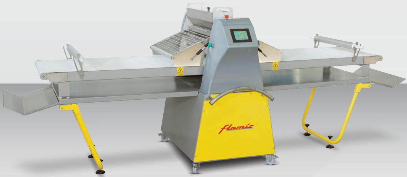
**Máquinas indicadas para grandes pastelerías que permiten un ciclo automático de elaboración de la pasta a través de recetas memorizadas en la pantalla táctil.**
