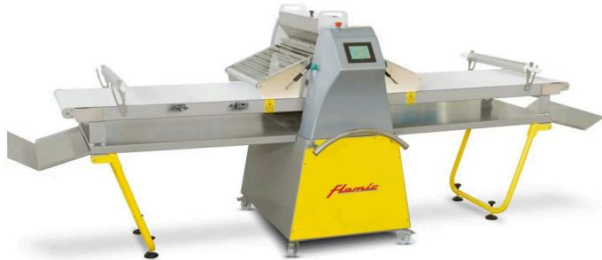
Тестораскаточная машина Flamic FAST700PX2000PST подходит для больших кондитерских цехов, лабораторий, которые используют автоматическую обработку изделий из теста на основе рецептов, сохраненных в памяти сенсорной панели управления. Воздействует на тесто с помощью валиков и превращает массу в ровный пласт нужной толщины. В результате получается идеально раскатанный пласт теста, готовый к дальнейшей обработке.
